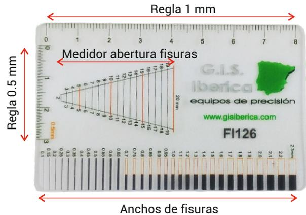
Usaremos Medidor abertura fisuras
