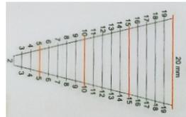
2. Colocar el fisurómetro en la pared.
