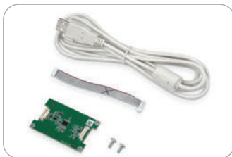
INTERFAZ DE DISPOSITIVO USB KIT I-DT33 30699120
