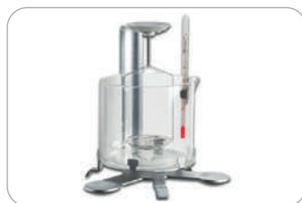
KIT DE DETERMINACIÓN DENSIDAD PARA SÓLIDOS 80253384
