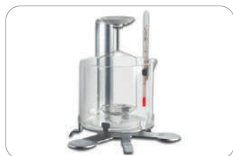
KIT DE DETERMINACIÓN DENSIDAD PARA SÓLIDOS 80253384
